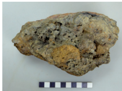
Afb. 11.5a Onderzijde van ovenslak vondstnummer 728. De slak is deels tussen houtskool door gedruppeld. Langs de bovenrand is oranje gebrande leem van de ovenwand te zien. De schaalverdeling is in cm.
