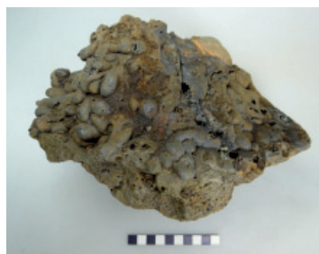
Afb. 11.3b Tapslak vondstnummer 204. De slak is in meerdere lagen over elkaar uit de oven gevloeid. De ovenwand is rechtsachter te zien. De schaalverdeling is in cm.
